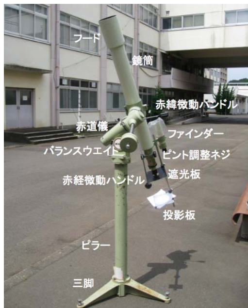
図3 天体望遠鏡に取り付けた太陽投影板
