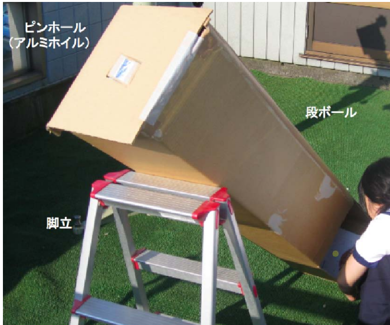
図7 1.5cmの太陽像が映る太陽観察用ピンホール望遠鏡
